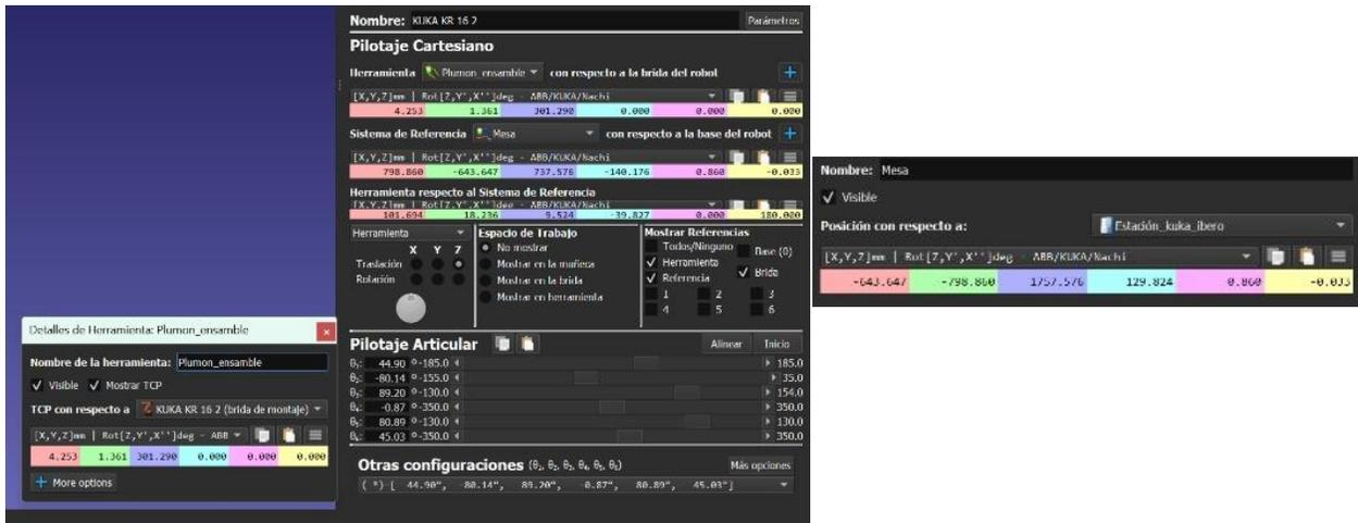
Fig. 4 Configuración de marcos de referencia de herramienta y mesa.
